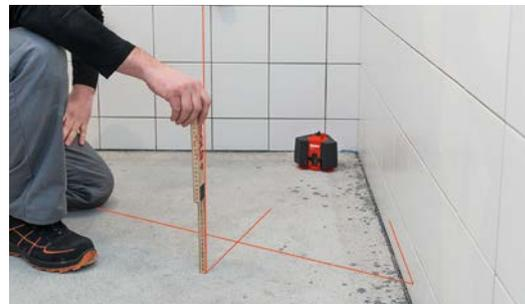
Das Messen der Bodenebenenheiten gelingt schnell und einfach dank der horizontalen Laserlinie, welche nahe über dem Boden verläuft. Mittels Meterstab kann dadurch die Bodenbeschaffenheit bestimmt werden.
