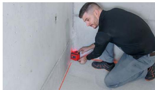
Werden die Bodenlinien des Lasers nahe der Wand ausgerichtet, lässt sich kinderleicht die Rechtwinkligkeit der Wände nachmessen.
